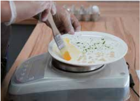
Für die Tests von Spülmaschinen wird Geschirr nach festgelegten Mustern verschmutzt.
