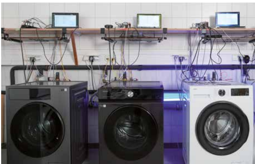
Mit standardisierten Tests ermitteln die Ingenieure im DA-ETO, wie die gewünschten Waschergebnisse komfortabel, sicher und energieeffizient erreicht werden können.
