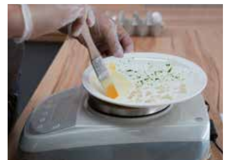
Für die Tests von Spülmaschinen wird Geschirr nach festgelegten Mustern verschmutzt.
