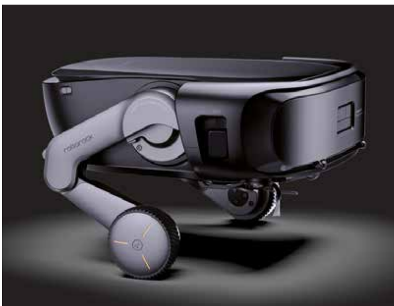
Mit ausfahrbaren Beinen soll der Saros Rover von Roborock Hindernisse und Treppen überwinden können. (Foto: Roborock)
