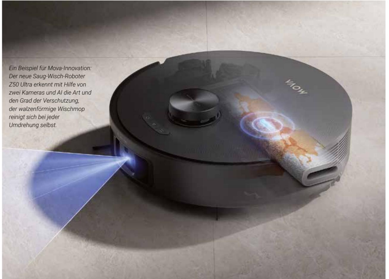
Ein Beispiel für Mova-Innovation: Der neue Saug-Wisch-Roboter Z50 Ultra erkennt mit Hilfe von zwei Kameras und AI die Art und den Grad der Verschmutzung, der walzenförmige Wischmop reinigt sich bei jeder Umdrehung selbst.
