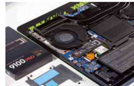
Mit einer Höhe von nur 8,88 mm (mit Kühlkörper) entsprechen die 1 TB, 2TB und 4 TB Versionen der SSD dem PCI-SIG D8-Standard und passen daher in zahlreiche mobile Rechner.
