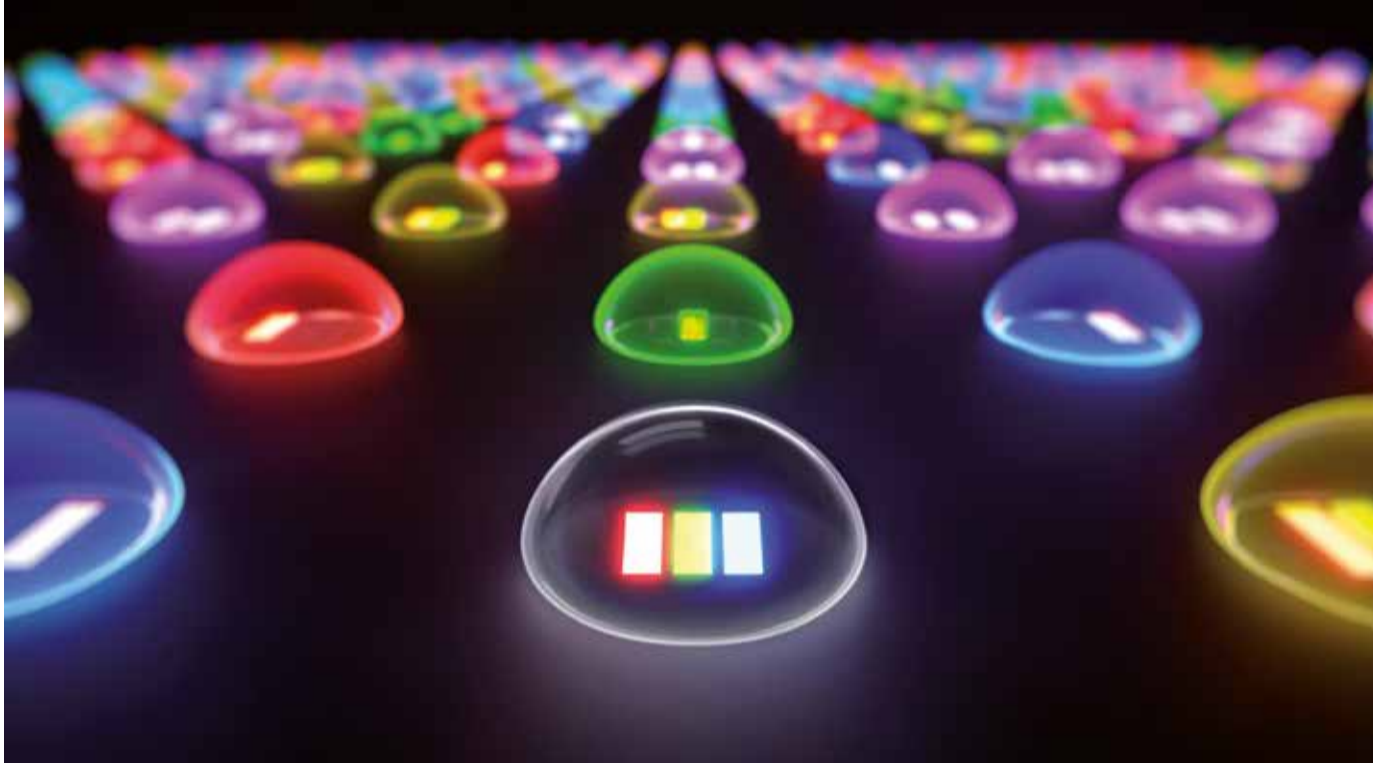
Bei dem neuen Display-System werden besonders dicht gepackte LEDs eingesetzt, die in der Lage sind, die jeweils gewünschte Grundfarbe (rot, grün oder blau) zu emittieren.
