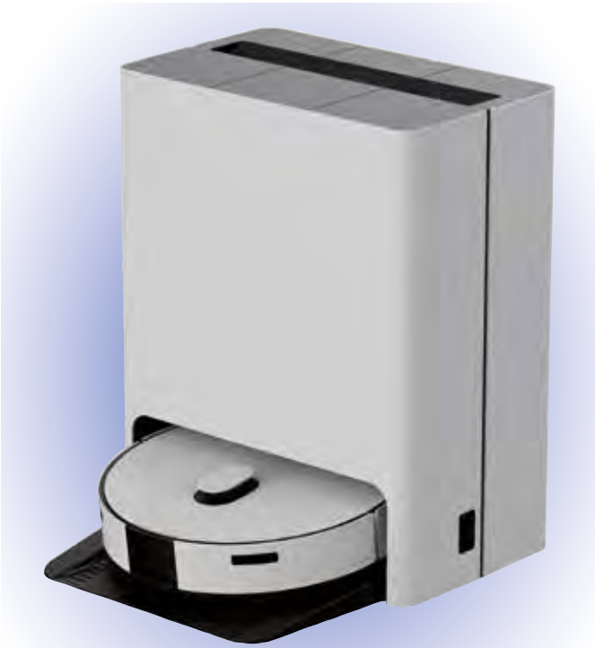
An der Basisstation können die Wischpads des Bespoke Jet Bot Combo mit heißem Dampf erhitzt werden.
