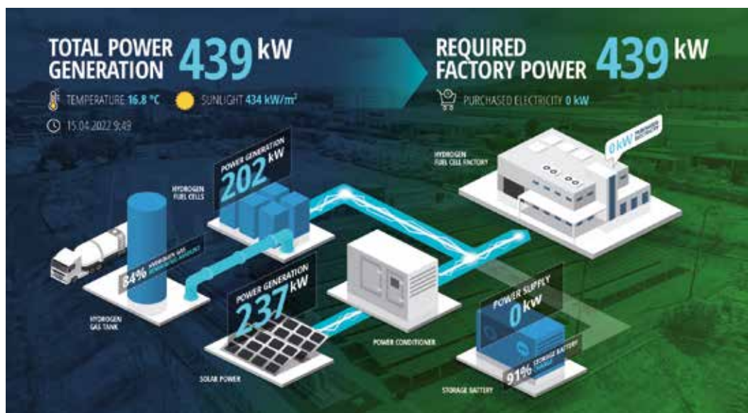
Seit April 2022 arbeitet eine Panasonic Fabrik in Japan dank Wasserstoff, Brennstoffzellen, Photovoltaik und einem Batteriespeicher ausschließlich mit Strom, der zu 100 Prozent aus erneuerbaren Ressourcen gewonnen wird.
