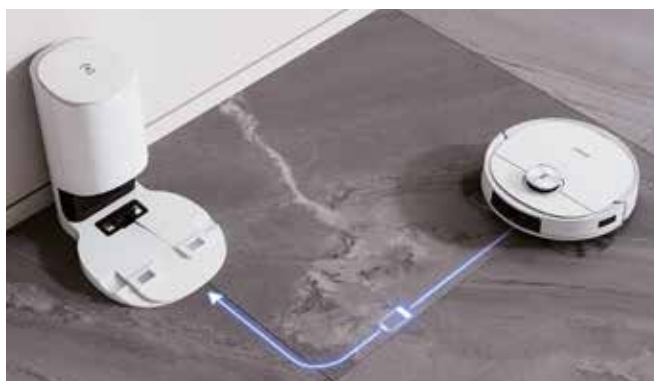
Ist der Akku leer, fährt der Roboter automatisch zum Ladegerät (hier mit optionaler Absaugstation) zurück.
