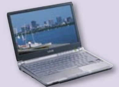
2004: Erstes in Großserie gefertigtes Notebook mit der stromsparenden LED-Backlight-Technologie (VAIO VGN-TX1).
