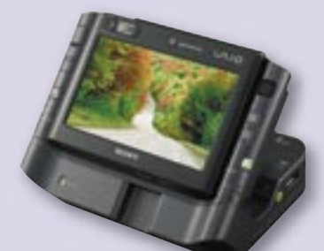
2007: Kleinster Ultra Mobil PC mit kompletter Windows XP-Ausstattung und vollwertiger Schiebetastatur (VAIO VGN-UX1).
