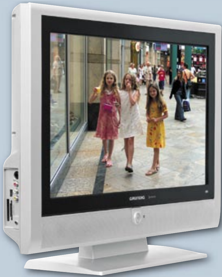
Die Lenaro Connect-Modelle von Grundig sind mit einem Digital Media Player ausgestattet, der die gängigsten Speicherkartenformate SD, MS, CF, MMC, SM und XD liest.
