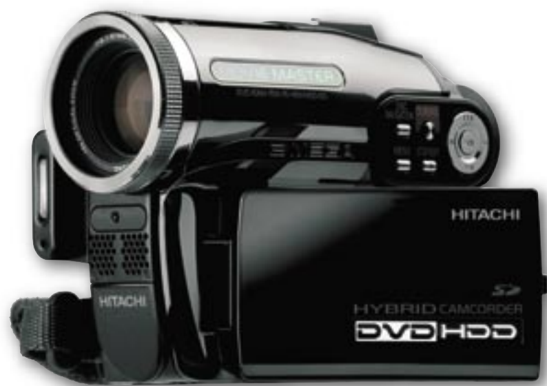
Die neuen Hybrid-Camcorder von Hitachi sind sowohl für die Aufzeichnung auf DVD als auch auf Festplatte geeignet. Somit ermöglichen die Geräte besonders flexible Aufnahmen.
