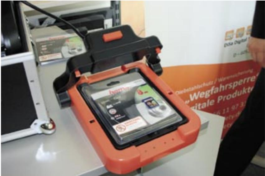
Die Handhabung des DiSa Activators an der Kasse ist einfach: Die Ware wird in der Blister-Verpackung eingelegt, der Riegel einmal nach unten gedrückt und wieder angehoben. Dieser Vorgang dauert nur wenige Sekunden.
