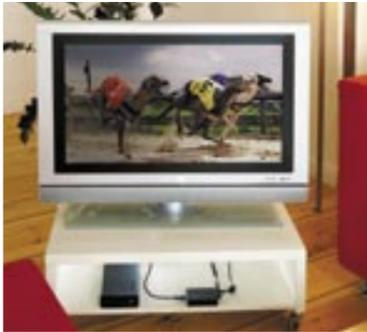
lieferten SCART-Anschluss oder das AV-Kabelset mit dem Fernseher verbunden. Über ein On-Screen-Menü auf dem Fernseher lässt sich die Einheit nun per Fernbedienung steuern. Der MediaPlayer XS unterstützt sämtliche gängigen Videoformate, wie MPEG-1, 2, 4, DivX, Xvid, Audioformate wie MP3, WMA, WAV oder JPG-Fotoformate. Die Firmware wird stetig weiterentwickelt und online zum Download bereitgestellt.
