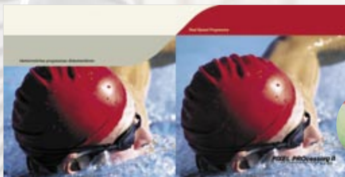
„Real Speed Progressive“ macht aus Halbbildern durch progressives Abtasten Vollbilder.
