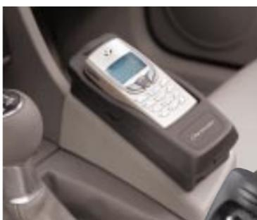
Die Elektronik der neuen variocom VC3 steckt in einer handlichen Basisstation.
