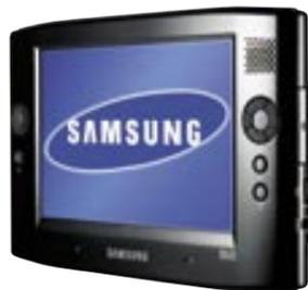
Im Q1b arbeitet ein VIA C7-M Prozessor 770 mit 1 Ghz Taktfrequenz, 1 MB Cache und 400 MHz Frontsidebus, unterstützt von 1.024 MB (1GB) PC2-4200 Arbeitsspeicher. Als Betriebssystem ist Windows XP Tablet PC
