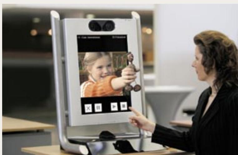
Das 3D-Center besteht aus einem hochauflösenden Monitor mit in den Rahmen integrierten Kameras.
