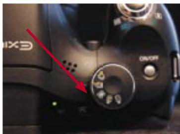
Bei der Exilim EX-FH20 lässt sich die Highspeed-Funktion ganz einfach am Bedientknopf an der Kameraoberseite einstellen.
