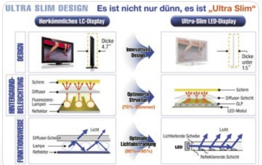
Verglichen mit einer traditionellen CCFL (Kaltkathodenfluoreszenzlampen) erzeugen LEDs dunklere Schwarztöne, die dem Auge endlos tief erscheinen. Der Schirm lässt effektiv mehr Licht durch und reduziert gleichzeitig durch Umgebungslicht erzeugte Reflexionen. Durch das Ultra Clear Panel bleibt auch bei geringem Umgebungslicht jedes Detail erhalten.
