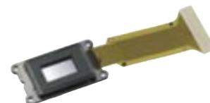
Das SXRD Projektionssystem arbeitet mit drei LCD-Chips mit je 2.073.600 Pixeln in den Grundfarben R/G/B.
