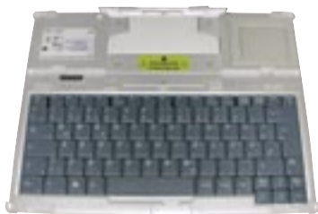
Eine ausklappbare Stütze und federnde Kontakt-leiste ermöglichen die einfache Einstellung des Tablet-PC in die großzügig dimensionierte Notebooktastatur.
