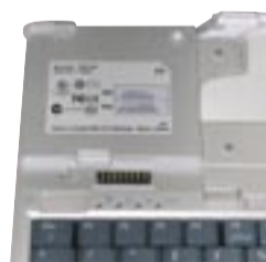
Eine federnde Kontaktleiste stellt durch einfaches Einstellen den Kontakt zwischen Unterteil und Tablet-PC her.
