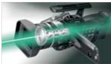
Die weich arbeitende, optische Stabilisierung vermeidet gegenüber einer elektronischen jegliche Art von Bildveränderungen.
