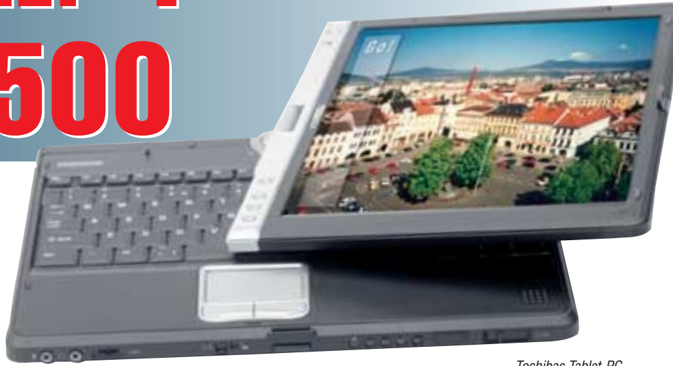
Toshibas Tablet-PC Portégé 3500 ist ein mit stromsparendem 1.333 GHz Intel Mobile Pentium III Prozessor-M und 40 GB Festplatte ausgestattetes leistungsfähiges Notebook, dessen elektromagnetisch sensitives Display mit einem leichten Schwenk gedreht und als Schreibfläche eines Tablet-PC benutzt werden kann.
