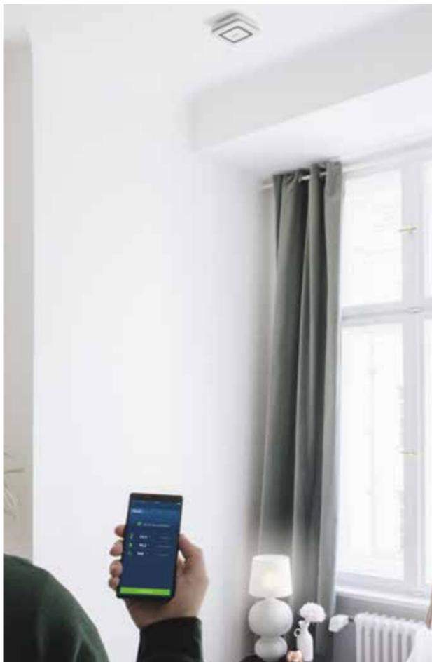
wacht wird. Genau das kann der Twinguard Rauchwarnmelder von Bosch Smart Home. Denn er enthält einen eigens von Bosch entwickelten Sensor, der kontinuierlich die Temperatur, relative Luftfeuchtigkeit und die Reinheit der Raumluft überwacht und frühzeitig warnt, wenn die
