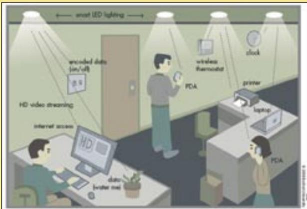
In Smart Lightning Daten-Netzwerken erfolgt die Datenübertragung zwischen den verschiedenen Netzwerk-Geräten über das von LED-basierten Beleuchtungskörpern ausgestrahlte Licht.
