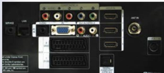
Das rückwärtige Anschluss-Terminal stellt neben Standard-Eingängen und -Ausgängen drei HDMI-Schnittstellen, digitale DVI-Schnittstelle, PC-Grafik-Anschluss (D-Sub) und LAN/Ethernet Buchse bereit.
