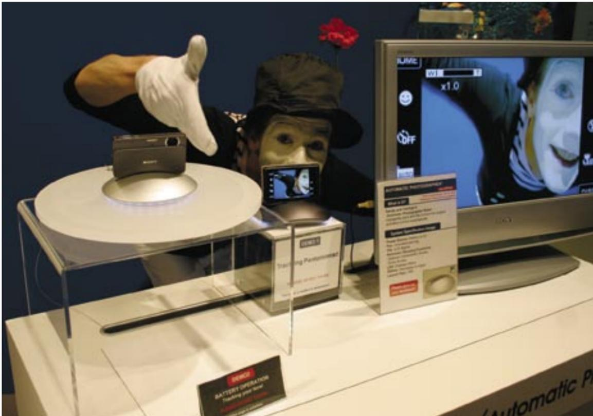
Eine „neue Art des Fotografierens“ wurde am Sony-Stand demonstriert: Der „automatische Fotograf“ ist ein batteriebetriebener Kamera-Halter, auf dem sich eine Digitalkamera dreht. Dabei erkennt das Gerät mit Hilfe der Gesichtserkennung automatisch lohnende Motive und macht selbständig Bilder – keine schlechte Idee, um auf einer Party zu originellen Schnappschüssen zu kommen.
