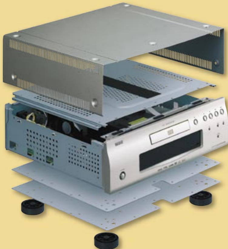
Auch unter der Haube steckt Präzision. Die Schaltkreise sind innerhalb des Gehäuses in drei unabhängige Blöcke unterteilt. Die obere Abdeckung besteht aus einer Zwei-Schicht-Konstruktion, während der Gehäusoboden aus drei Schichten konstruiert wurde, um die Schaltkreise gegen Vibrationen zu schützen.
