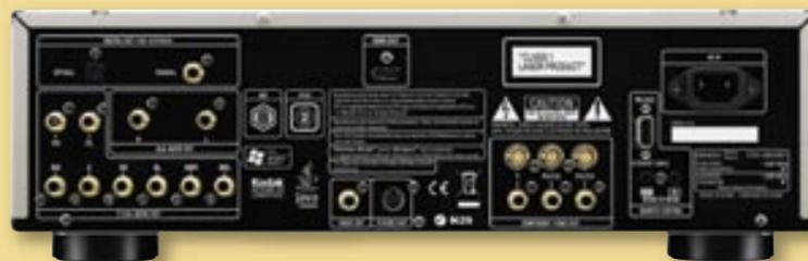
Trotz seiner High-End-Ambitionen wirkt die Rückseite von Denons Flaggschiff aufgeräumt und übersichtlich. Ein HDMI-Ausgang sorgt für den digitalen Bild- und Tontransport. Zusätzlich stehen ein Komponenten-, S-Video- und Composite-Ausgang bereit. Digitale Tonsignale liefern der Optische- und Koaxiale Ausgang. Der 7.1-Ausgang schafft Anschluss für die Surround-Anlage.
