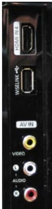
Das vordere Anschluss-Terminal bietet neben HDMI und Composite Video Eingang einen Wiselink Pro USB 2.0 Port für portable Multimedia-Player mit Video, MP3, und JPEG Inhalten.
