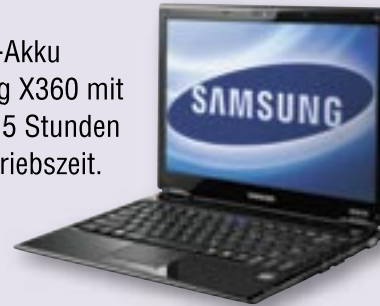
Bei dem X360 Notebook setzt Samsung einen mit 1,2 GHz getakteten Intel Core 2 Duo SU9300 Prozessor ein. Die Größe des Arbeitsspeichers beträgt mindestens 1 GByte.
