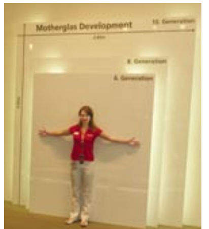
Größenvergleich Muttergläser für LCD-TV: Sharp produziert auf modernsten 8G-Anlagen. Die weltgrößte 10G-Fertigungsanlage ist im Bau.
