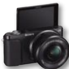
Der 7,5 cm (3“) große LCD-Monitor der NEX-3N kann um 180 Grad nach oben geklappt werden.
