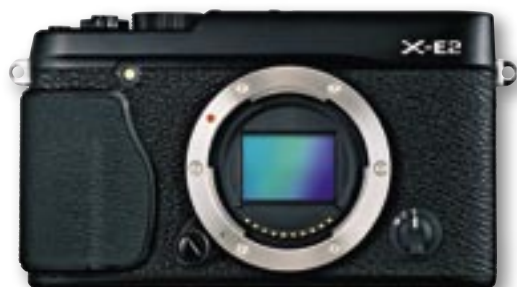
Soll mit ihrem X-Trans CMOS II-Sensor im APS-C-Format Vollformat-Qualität bieten: die Fujifilm X-E2
