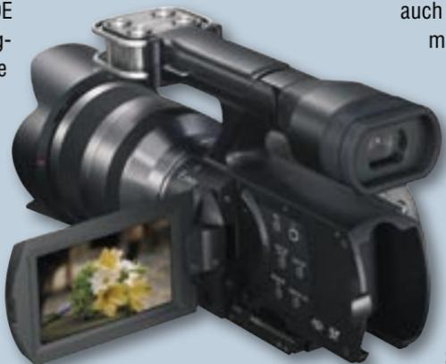
und ermöglicht progressive Aufnahmen mit manueller Tiefenschärfekontrolle (50p/25p). Für die Bildqualität ist unter anderem der APS-C HD CMOS Exmor-Sensor mit 16.1 Megapixeln verantwortlich. Er ermöglicht
