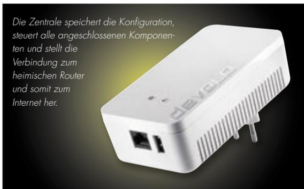
Die Zentrale speichert die Konfiguration, steuert alle angeschlossenen Komponenten und stellt die Verbindung zum heimischen Router und somit zum Internet her.
