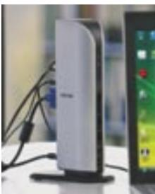
stößeln von Steckern und Kabeln ist nicht mehr nötig. Neben einem digitalen Videoausgang (DVI-I) wartet Toshibas neuer Schnittstellen-Replikator zudem mit sechs USB-2.0-Anschlüssen, einem zusätzlichen Eingang für 10/100-Ethernet-LAN, einem SP/DIF-Ausgang (7.1-Kanal) sowie einem Lautsprecher-Ausgang und einem Mi-
