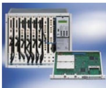
ben neue Twin-Kassetten und eine neue AV-Kassette an. Da diese Kassetten im Gegensatz zu den Vorgängerversionen Vollbandmodulatoren haben, lassen sie sich universell programmieren. Zugleich konnten so die Kassettenvarianten verringert werden. Dadurch reduziert sich der Aufwand für Planung und Lagerhaltung
