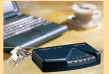
die ISDN-Verbindung dann augenblicklich herstellen. Dank seiner mobilen Auslegung läßt sich der Agfeo USB Plug flexibel einsetzen und ist an allen Euro ISDN-TK-Anlagen mit internem S<sub>0</sub>-Bus oder direkt am NTBA zu betreiben. Die unverbindliche Preisempfehlung lautet 199 DM.
