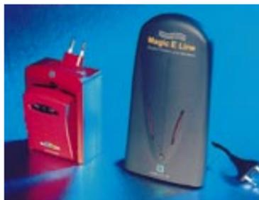
Das Digital Power Line Modem von Keyin Telecom, das derzeit in Essen eingesetzt wird (r.), ist noch relativ groß und benötigt neben der Kabelverbindung zum Rechner auch noch eine Stromleitung. Zukünftige Modelle (links eine Designstudie) sollen direkt in die Steckdose gesteckt werden können. Foto: RWE/Laaks
