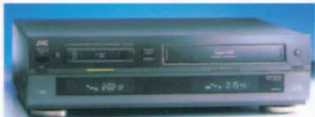
dem SR-VS10E lassen sich S-VHS/VHS- und DV-Bänder nicht nur komfortabel aufzeichnen und abspielen, auch die Überspielung von einem zum anderen System ist ohne Verkabelung möglich. Zusätzlich verfügt der SR-VS10E über einen TV-Tuner, so daß auch Fernsehaufzeichnungen möglich sind.
