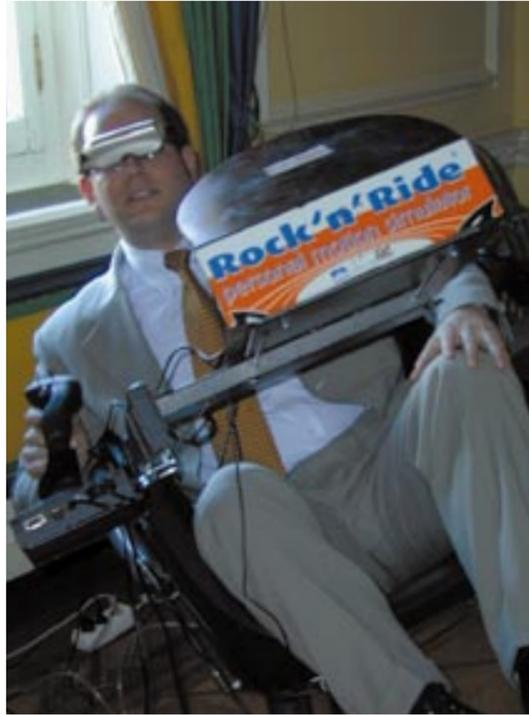
Rock'n Ride. Der Personal Motion Simulator ist ein Einsatzbeispiel für die Face Mounted Displays. Während der Anwender über die Brille ein Spiel verfolgt, bei dem er aus einem Flugschiff heraus Raketen abschießt, simuliert der Stuhl die dazugehörigen Bewegungsabläufe.
