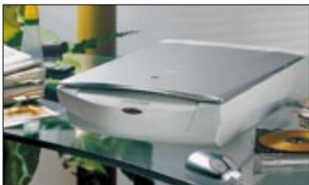
hohe Auflösungsleistung von echten 1200 dpi wieder. Der Flachbettscanner verfügt über eine USB-Schnittstelle und einen Scan-Button, über den der Scanvorgang direkt am Gerät gestartet werden kann. Der FB 1210u mißt gerade mal 28,6 x 46,1 cm bei einer Höhe von 9,25 cm und fällt durch seinen platinfarbenen Deckel auf. Er ist ab Juni lieferbar. Der Endverbraucherpreis wird bei 499 DM liegen.
