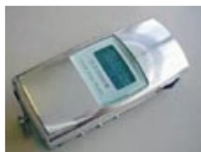
Bei Sanyos SSP-PD7 handelt es sich um einen Player mit 32 MB MultiMedia-Card, der mehrere Datenkompressionsverfahren wie MP3 und AAC erkennt, abspeichert und abspielen lassen kann. Das Gerät im runden Feuerzeug-
