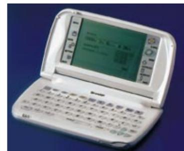
zern den schnellen Zugang zu Informationen aus dem Web. Das Gerät ist mit einem lesefreundlichen Display und einer QWERTY-Tastatur ausgestattet. Eine Vielzahl von Handys ist mit dem Gerät kompatibel. Commi Pal funktioniert auch als Organizer. Über eine Infrarotschnittstelle mit maximal 115kbps können Daten auf den stationären PC transferiert werden. Der Commi Pal ist voraussichtlich ab Sommer dieses Jahres lieferbar.
