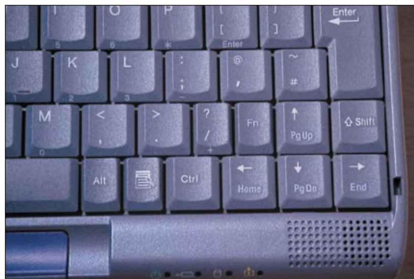
Panel-Panne: Der rechte Umschalter für Großbuchstaben sitzt etwas weit außen, vorne ist einer der Lautsprecher zu erkennen. Die deutsche Tastaturbelegung war zum Testzeitpunkt noch nicht fertig.
