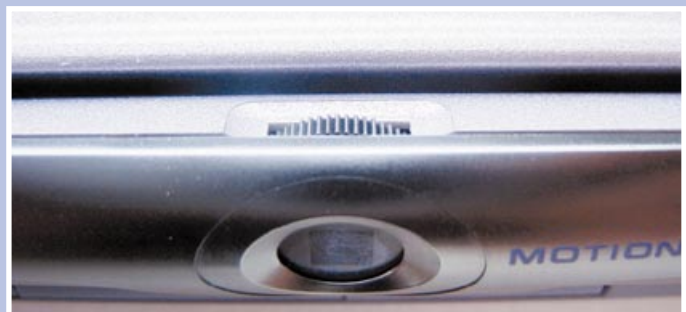
Magic Eye: Das Kamera-Auge ist kurzsichtig. Deshalb muß es mit einem Schärferegler manuell focussiert werden.
