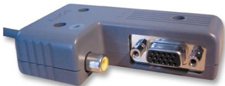
Schon dabei: der Adapter für Monitor und Fernseher. Damit auch im Hotelzimmer am großen Monitor gearbeitet werden kann. Eine Splitscreen-Einrichtung, um an zwei Monitoren parallel arbeiten zu können, bringt die Grafikkarte bereits mit.
