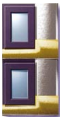
Links: Konventionelle CCD Struktur: In jedem Pixel befinden sich eine einzelne Fotodiode, der CCD Übertragungsweg und der Signalkontrollweg. Rechts: Pixelstruktur im Super CCD: Die Signalkontrollwege sind überflüssig, und die Pixel können in maximaler Dichte angeordnet werden.
