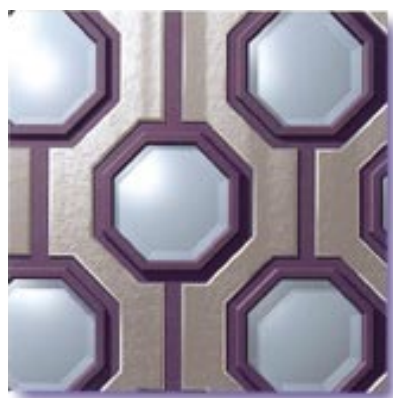
Links: Konventionelle CCD Struktur: In jedem Pixel befinden sich eine einzelne Fotodiode, der CCD Übertragungsweg und der Signalkontrollweg. Rechts: Pixelstruktur im Super CCD: Die Signalkontrollwege sind überflüssig, und die Pixel können in maximaler Dichte angeordnet werden.
