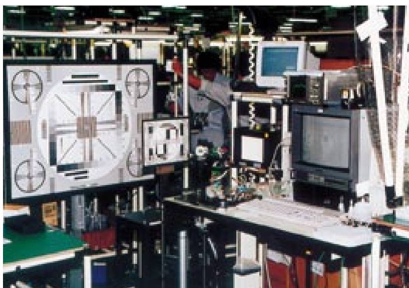
Die Montage der Digitalkameras erfolgt im Fujix Werk in Gruppen, die für die einzelnen Produktionsschritte von der Montage des Super CCDs bis zur Qualitätskontrolle verantwortlich sind.
