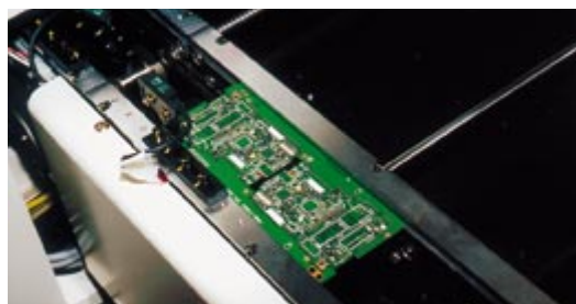
Moderne Industrieroboter bestücken die Leiterplatten für Digitalkameras automatisch und mit rasender Geschwindigkeit.
