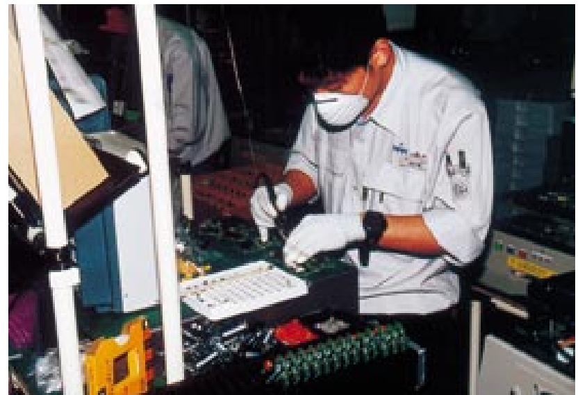
Die Montage der Digitalkameras erfolgt im Fujix Werk in Gruppen, die für die einzelnen Produktionsschritte von der Montage des Super CCDs bis zur Qualitätskontrolle verantwortlich sind.
