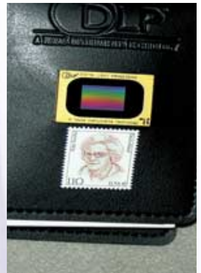
DLP-Chip mit 1,3 Millionen (1.310.000) mikroskopisch kleiner Spiegel im Größenvergleich.
