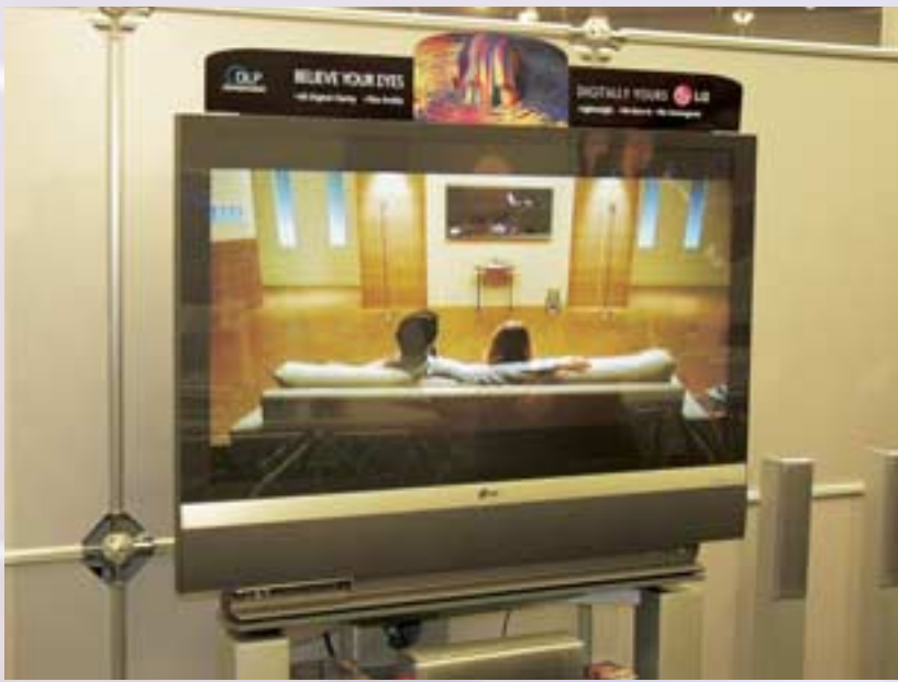
Mit nur 37 cm hat der RE-44SZ20 Rückprojektions-TV eine geringe Tiefe gegenüber 50 cm Tiefe bei gebräuchlichen CRT-TV's.
