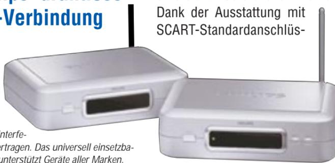
Philips präsentiert mit dem SBC VL 1200 eine kabellose TV-Verbindung, die ebenfalls dafür sorgt, daß auf einem Fernseher Videos, DVDs oder das TV-Programm geschaut werden können, ohne daß sich sonst benötigte Videorecorder, DVD-Player oder der Antennenanschluß in direkter Nähe des TV-Gerätes befinden. Der SBC VL 1200 überträgt Signale kabellos und interferenzfrei über eine Reichweite von 30 Metern, auch durch Zimmerwände oder -decken hindurch. Die TV-Verbindung be-
