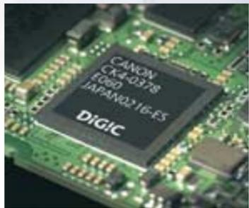
Kern der neuesten Canon-Digitalkameras ist der speziell für Imaging-Zwecke entwickelte DiGiC (Digital Imaging Core)-Prozessor.
