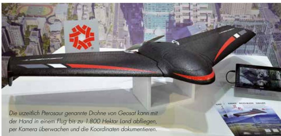
Die urzeitlich Pterosaur genannte Drohne von Geosat kann mit der Hand in einem Flug bis zu 1.800 Hektar Land abfliegen, per Kamera überwachen und die Koordinaten dokumentieren.
