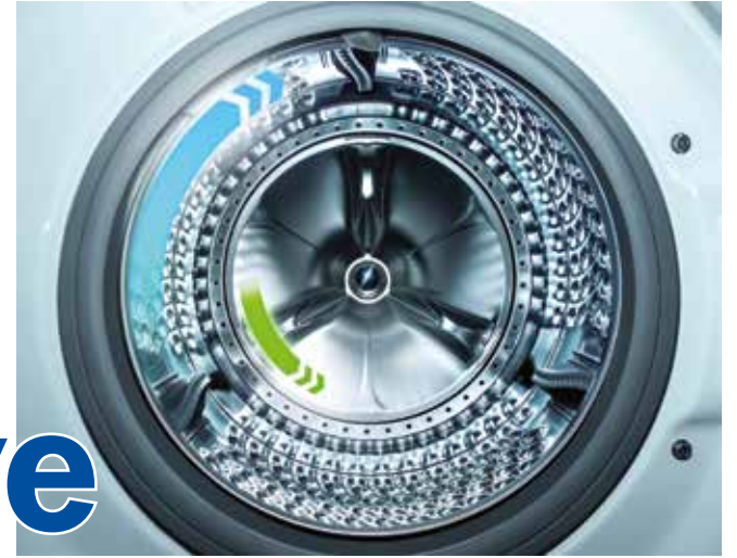
Die gegenläufige Drehung von Trommel und Rückwand erzeugt bei den QuickDrive-Waschmaschinen eine stärkere Bewegung der Wäsche, um die Waschzeit deutlich zu verkürzen.
