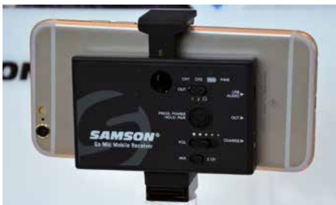
Das Stereo-Tonaufnahmesystem von Samson wird einfach ans Smartphone geklemmt und soll professionelle Klangqualität liefern.
